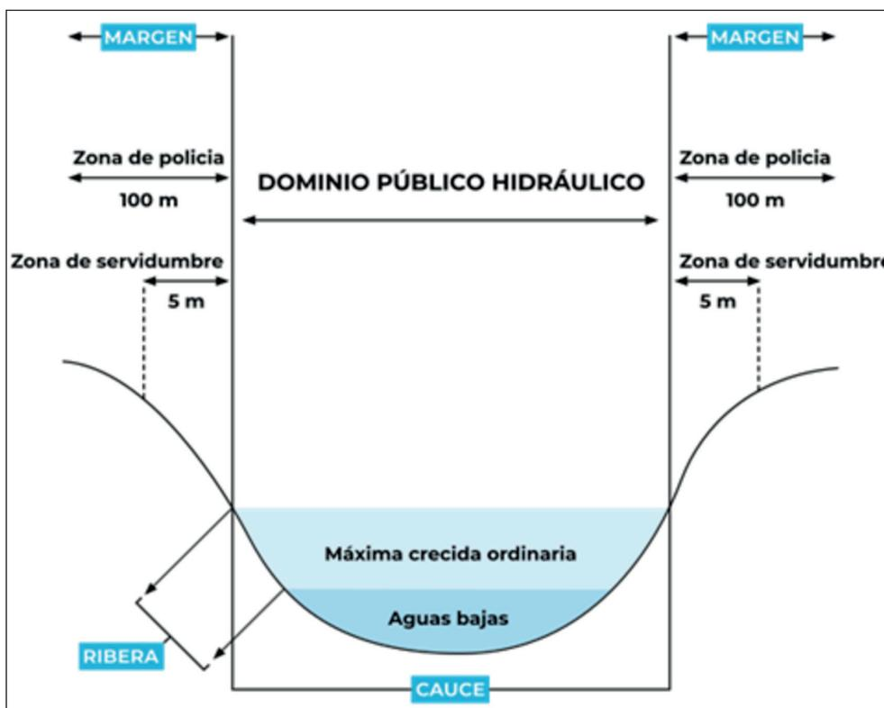
Figura 1. Sección tipo de un cauce
